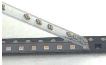
図 18. 帯電による LED 貼りつき
