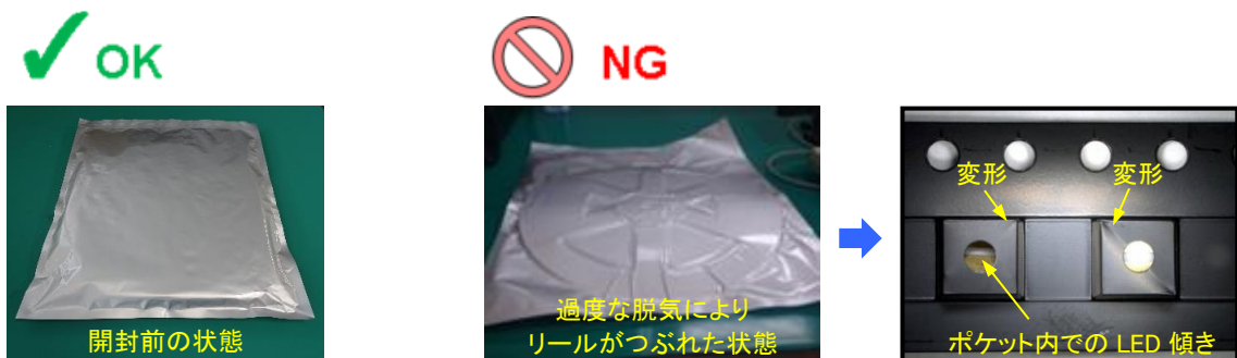
図 6. 過度な脱気状態によるエンボスキャリアテープの変形
