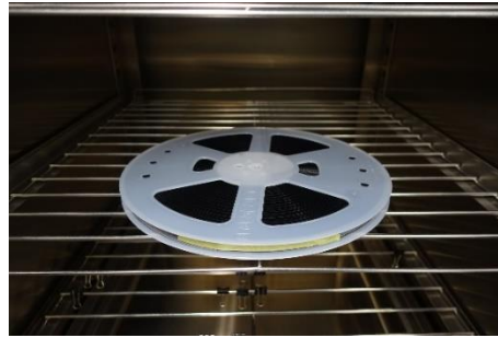
図 5. ベーキング処理の例
